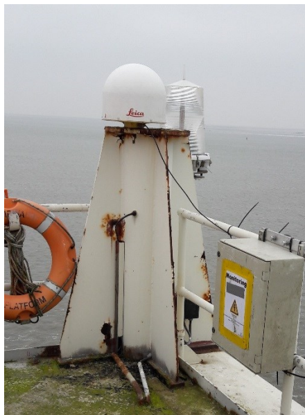
Figuur 5 Meetlocatie Zuidwal GPS-meting februari 2017 met een Leica AR25-choke ring antenne
