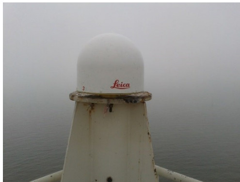
Figuur 4 Meetlocatie Zuidwal meting oktober 2011 met een Leica AR25 choke-ring antenne
